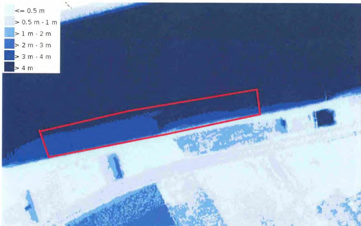
Abb. 3-1: Hochwassergefahrenkarte HQ 100 mit Wassertiefen im Planungsgebiet (Geodaten: Geoportal Wasser RLP, LVerm Geo RLP)
