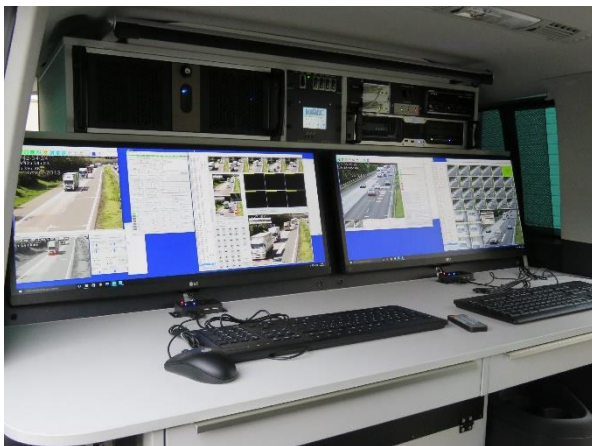
Der Auswerterechner und die Anzeigeeinheit des VKS 4.5-Systems.
