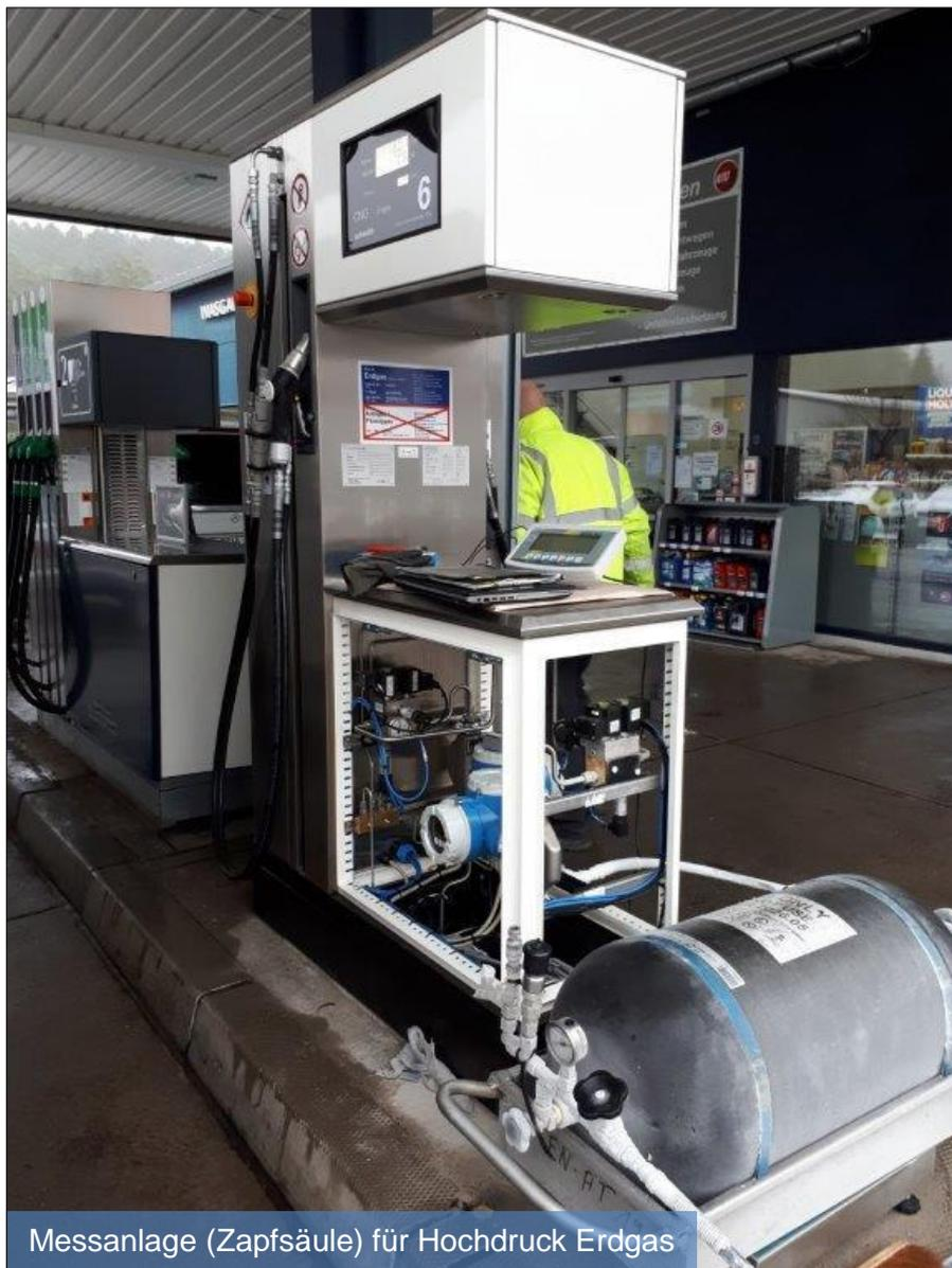
Messanlage (Zapfsäule) für Hochdruck Erdgas
