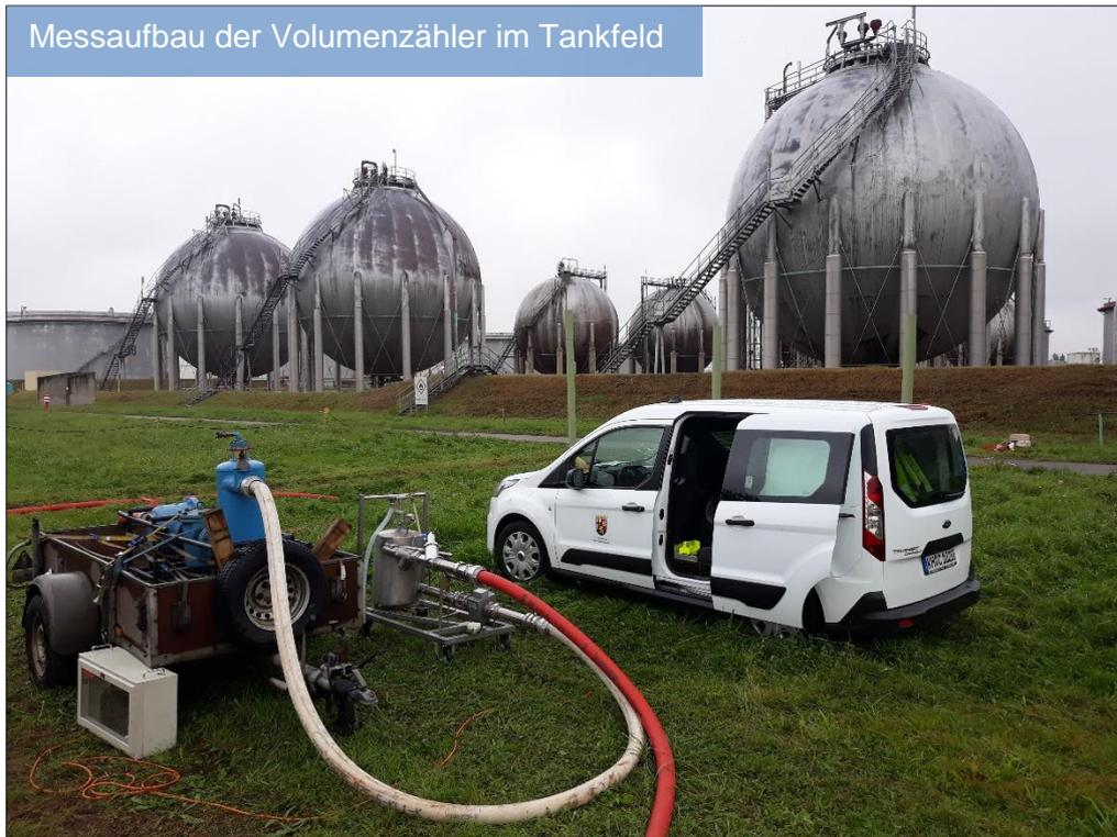
Die Befüllung der Behälter erfolgte mit aufbereitetem Flusswasser aus dem naheliegenden Rhein. Dafür wurde es in einem anderen Lagerbehälter vorgehalten und mit einer zuschaltbaren Pumpe über Schlauchleitungen mit einer konstant eingestellten Durchflussstärke zu den Zählern und dort über einen Bodenanschluss in den zu prüfenden Behälter gefüllt.
