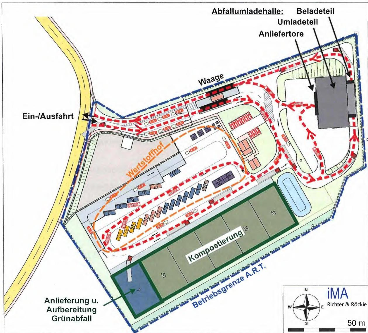
Abbildung 3-1: Lageplan des Betriebsgeländes und der drei Anlagenteile. Die Lage der Lkw-Fahrwege ist rot gestrichelt dargestellt (Plangrundlage: Ausführungsplan Anlage A-5, 30.09.2019)
