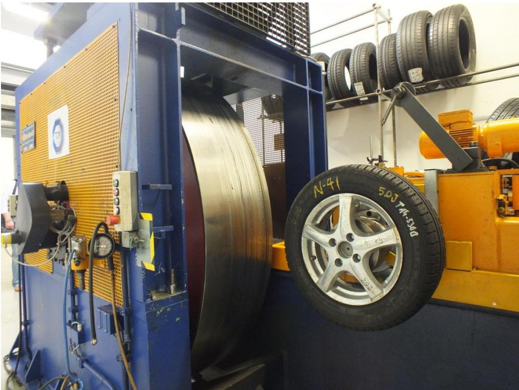
Der Prüfling durchläuft auf einem Rollenprüfstand ein automatisiertes Prüfprogramm. Der Reifen wird im Laufe der Prüfung auf unterschiedliche Geschwindigkeiten mit unterschiedlichen Anpressdrücken beschleunigt. Aus den gemessenen Kräften und Drehmomenten wird rechnerisch der Rollwiderstand des Reifens berechnet und der entsprechenden Energieeffizienzklasse zugeordnet.
