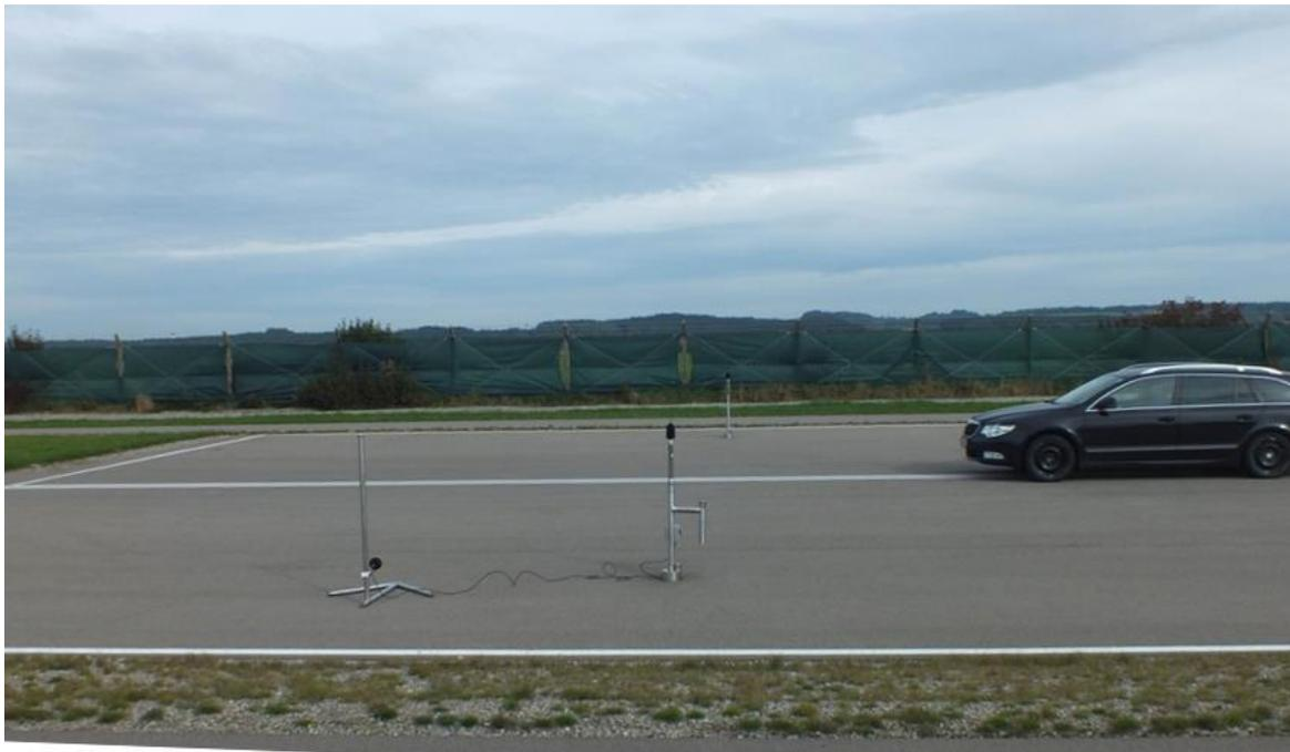
Ausgekuppelt und mit ausgeschaltetem Motor rollt das Messfahrzeug zwischen zwei Messmikrofonen hindurch, um den Schallpegel des Reifenabrollgeräusches zu messen.
