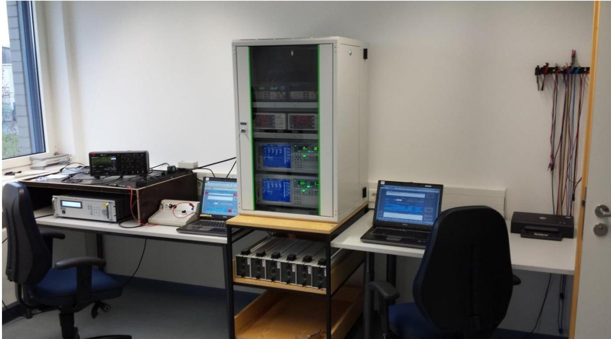
Hier werden an 2 Prüfplätzen Netzteile auf die Einhaltung der in der Verordnung (EG) 278/2009 festgelegten Ökodesign-Anforderungen an die Leistungsaufnahme bei Nulllast sowie ihre durchschnittliche Effizienz im Betrieb geprüft.
