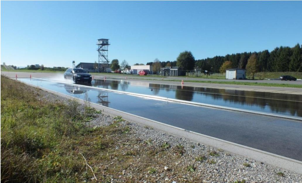
Die Prüfstrecke mit definiertem Reibungskoeffizient und Texturtiefe wird mit einem Wasserfilm (Dicke 0,5mm bis 1,5mm) bedeckt. Das Messfahrzeug verzögert auf dieser Strecke von 80 km/h auf 20 km/h. Aus der dafür benötigten Strecke und weiteren Parametern wird die Nasshaftungsklasse der Reifen bestimmt.
