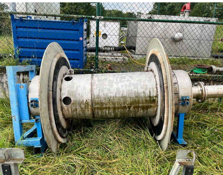
Die symmetrische Doppelkolbenkammer zur Entsandung
