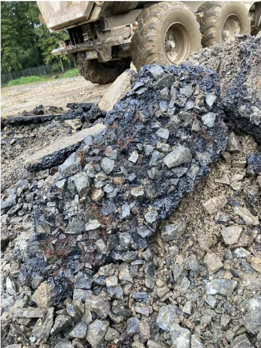
*Bild 2: organoleptisch auffällige Schwarzdecke und Tragschichtmaterial*
