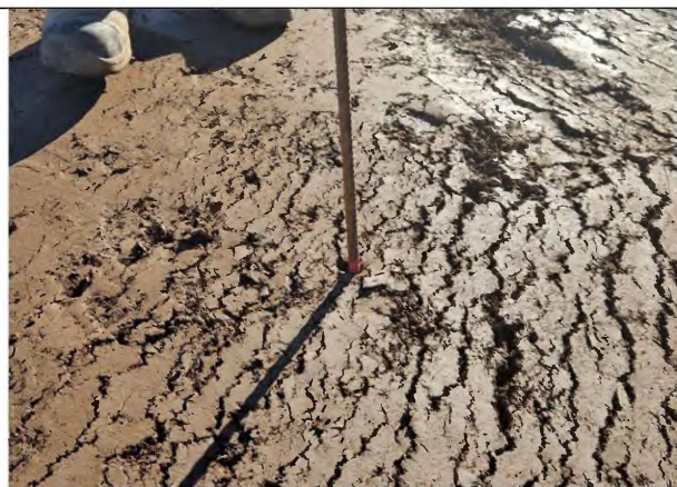
Foto 49: Bestimmung Mächtigkeit des aufgebrauchten Oberbodens
