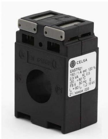
**Messwandler für Elektrizitätszähler** dienen der Anpassung von sehr großen elektrischen Strömen und/oder Spannungen auf ein für Elektrizitätszähler messbares Niveau. Der Strombereich geht dabei von ca. 100 Ampere bis zu mehreren Tausend Ampere und der Spannungsbereich von ca. 1.000 Volt bis zu 120.000 Volt
