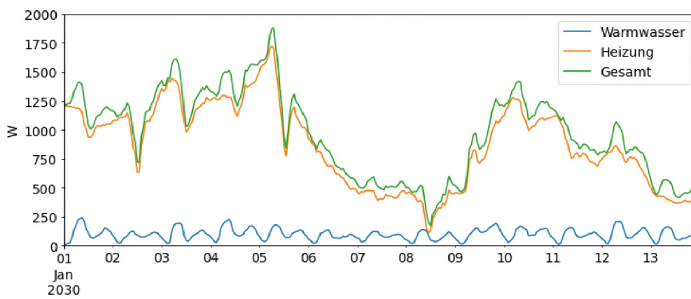
Abbildung 5-9: Lastprofil für eine Wärmepumpe
