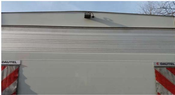
*Rückfahrkamera am Heck des Fahrzeuges*
