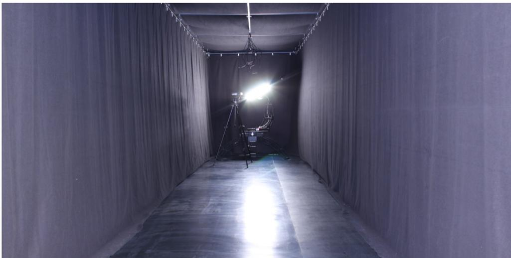
*Lichtmesssystem mit Spektroradiometer und Goniometer im Lichtkanal*
