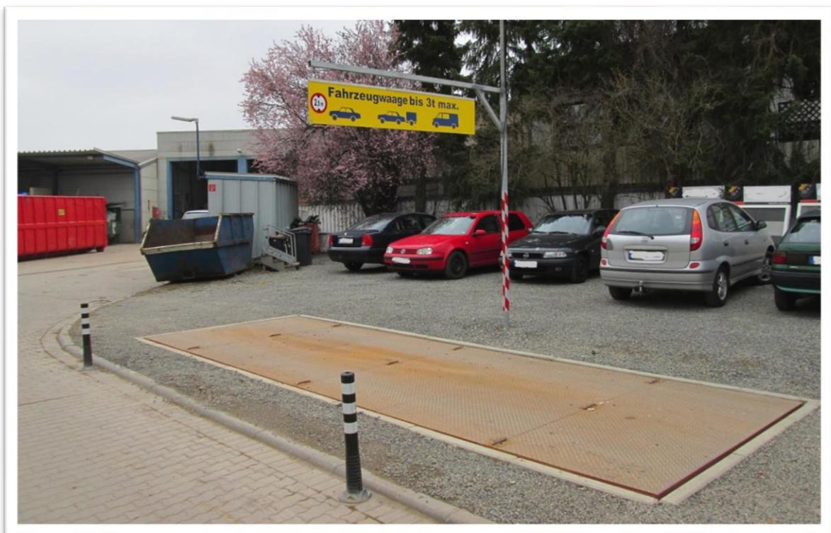
*3-t-Fahrzeugwaage zum Wiegen von PKW*
