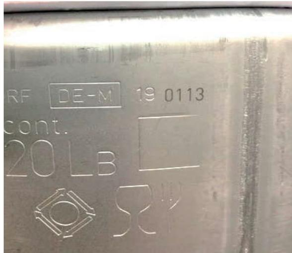
Konformitätskennzeichnung auf einem 20 L KEG-Fass
