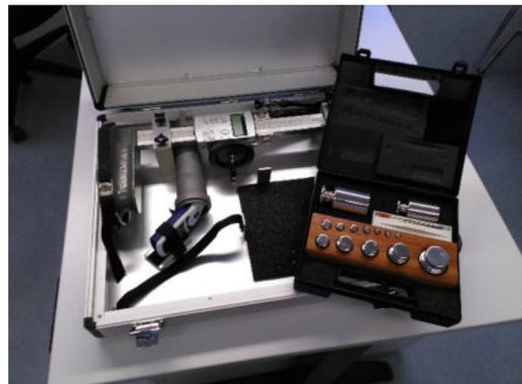
Elektronische Pipette, Höhenreißer mit Prüfspitzen und Gewichtesatz
