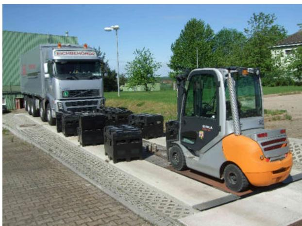
Auch in 2019 wurde die regelmäßige Überwachung der Straßenfahrzeugwaagen fortgesetzt. Diese Überwachung stellt eine wichtige Ergänzung zur Gewährung der Messrichtigkeit bei der Verwiegung großer Massen neben den turnusgemäß erforderlichen Eichungen dar. So waren es in diesem Jahr 60 Fahrzeugwaagen, die angefahren und auf Einhaltung der gesetzlichen Anforderungen überprüft wurden.
