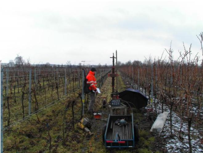
Bild 13: Rammsondierung bei BS/DPH 24
