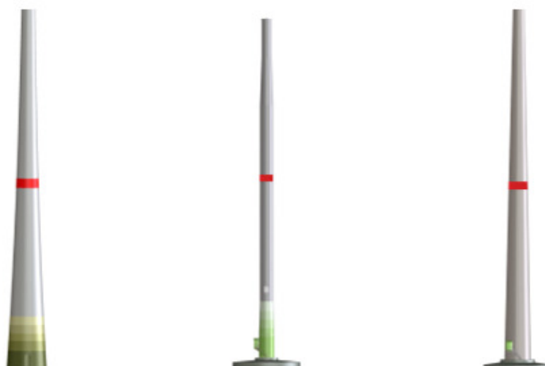
Abb. 7: Farbliche Kennzeichnung am Turm, beispielhafte Darstellung
