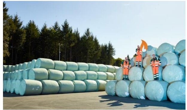
Abb.: Energiedepot – ballierter Restabfall im Zwischenlager
