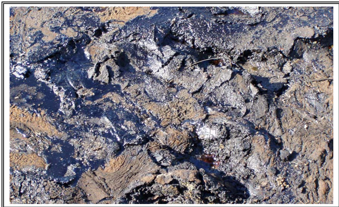
Foto 12: Konsistenzänderung der Teichoberfläche mit zunehmender Temperatur
