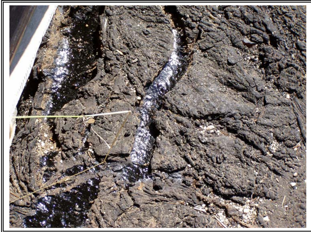
Foto 7: Konsistenz / Beschaffenheit der Säureteere an der Oberfläche
